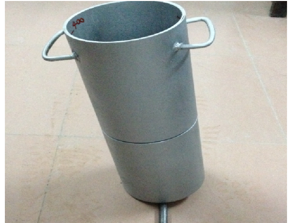
图3 离析率试验钢模
